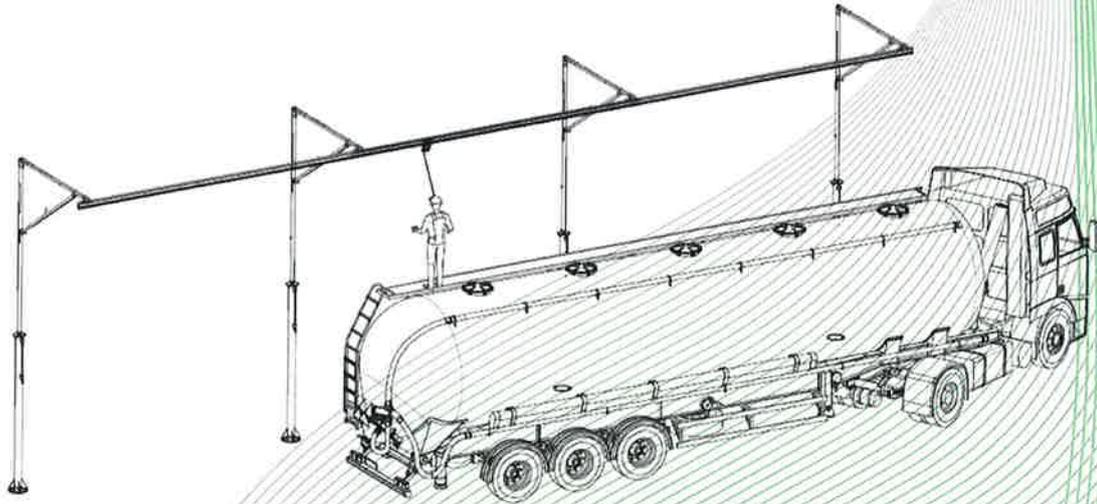
Ilustración 7: Dispositivo de anclaje del tipo D (tipo: Horizontal Safeaccess y NAV2 trolley / fabricante: FALLPROTEC SA) con anclajes, tipo: AlsiPercha y Post for reduced spaces
