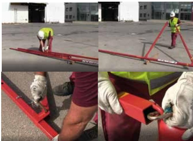
Evita la caída del trabajador bloqueando su descenso gracias a la utilización y montaje del sistema Alsipercha es fácil e intuitivo. al dispositivo retráctil, que se activa en cuanto detecta una En apenas unos pocos pasos ya puede comenzar a utilizarse. aceleración brusca producto de una caída.
