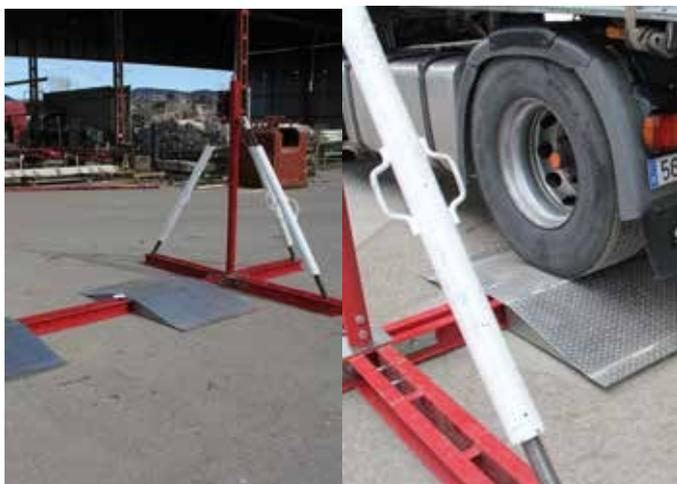
Una vez montada la estructura del SISTEMA DE CONTRAPESO Seguidamente, se corregirán las posibles desviaciones de nivel MF, colocaremos las rampas que servirán de apoyo de los camiones que se posarán por encima.
