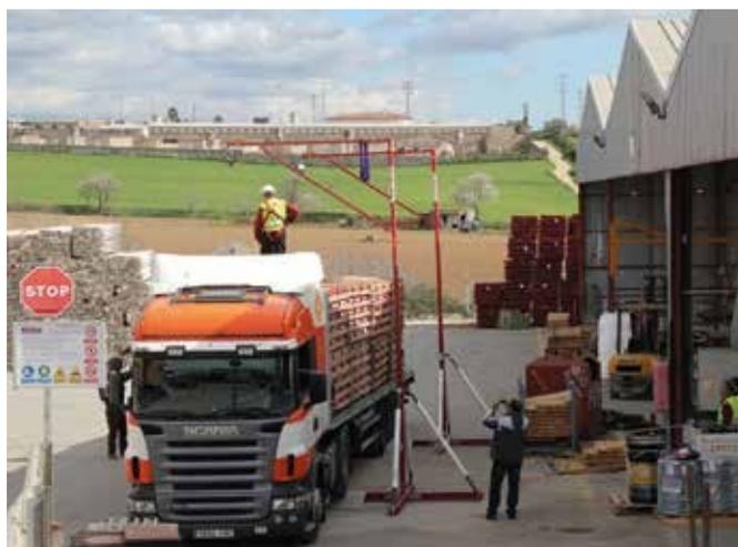
El usuario ya estará en disposición de conectarse al dispositivo tréctil conectado al Alsipercha, y comenzar a desempeñar sus labores con total protección.
