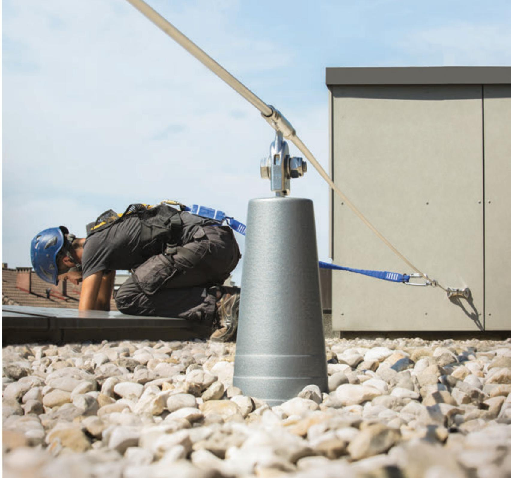
→ El poste Diasafe se usa como soporte de fijación para la línea de vida SecuRope o como punto de anclaje para 1 o 2 usuarios. Se puede instalar sobre techos horizontales con pendientes de hasta 5°. El poste está equipado con un dispositivo de absorción de energía.
