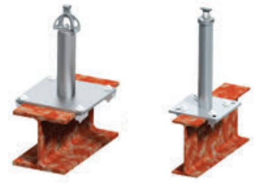
Modelado CAD de los soportes de fijación mediante pinzas para mantener una distancia estable entre las líneas de vida y las pasarelas.
