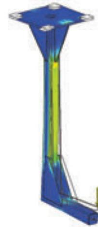
Cálculo de esfuerzo para fijación en viga.
