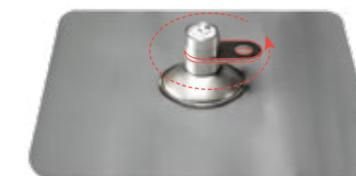
El SpotAnchor se instala en tejados de cubiertas tipo hot deck para asegurar áreas específicas tales como zonas de acceso, esquinas de edificios o techos pequeños. El toggle de alta resistencia garantiza una fijación segura a la chapa grecada y minimiza la posibilidad de puentes térmicos. El collar bituminoso o en PVC-P puede suministrarse pre-montado para comodidad del instalador. El punto de anclaje giratorio sigue el movimiento del operario.
