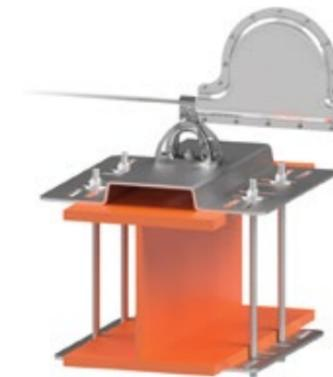
Fijación contraplacada en una viga de acero horizontal. Compatible con todos los dispositivos de anclaje Fallprotec para líneas de vida horizontales o inclinadas. Utilizable para madera y hormigón.
